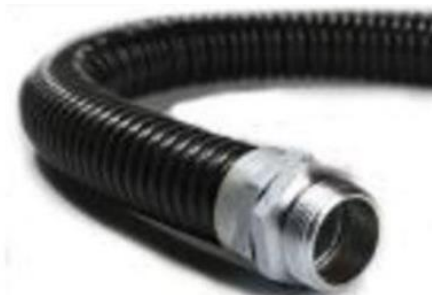
Imagem 8 – ELETRODUTO FLEXIVEL, EM FITA DE AÇO GALVANIZADO, REVESTIDO COM PVC PRETO, DIAMETRO EXTERNO DE 25 MM, DN = 3/4", TIPO SEALTUBO (Imagem ilustrativa)
